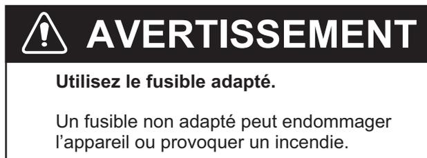
Le fusible (type : FGBO-A 125V 3A PBF, code n° : 000-155-850-10) intégré au câble d'alimentation protège l'unité des surtensions et des défaillances de l'appareil. Si l'appareil ne s'allume pas, contrôlez d'abord le fusible. Si le fusible a fondu, remplacez-le par le fusible spécifié. S'il fond à nouveau après un remplacement, contactez votre revendeur.
