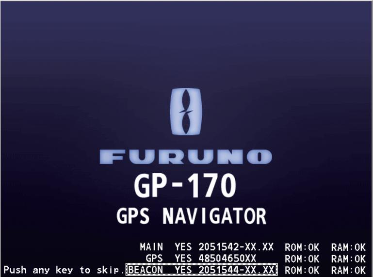
Apparaît lorsqu'un récepteur différentiel interne est installé.
